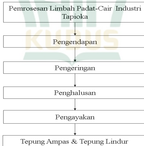
Gambar 4. 5 Proses Pengolahan Limbah Padat-Cair Industri Tapioka 4
