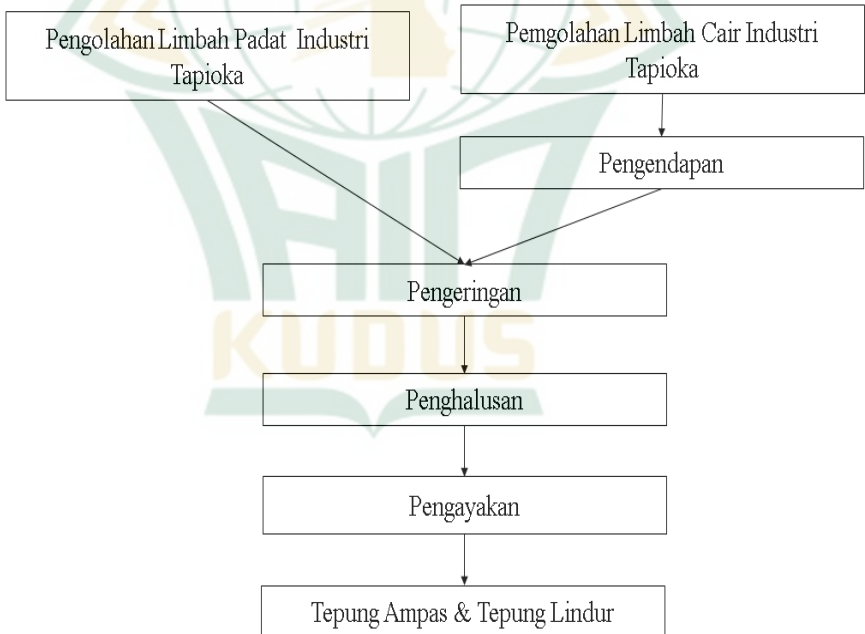
Gambar 4. 46 Proses Pengolahan Limbah Padat-Cair Industri Tapioka Menjadi Tepung
