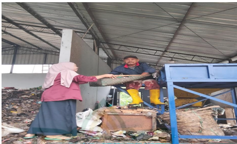
Gambar 1.8 proses memasukkan sampah organik ke dalam mesin bioreaktor kapal selam
