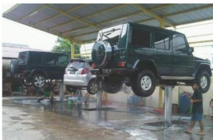
Gambar 2. 5 Pompa Hidrolik Pengangkat Mobil
