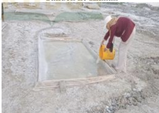
Gambar 4.7. Proses Pemindahan Air Garam dari Tandon ke Klakah
