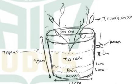
Pada Gambar 4.2 dapat dilihat bahwa desain *constructed wetland* yang dirancang merupakan tipe aliran bawah permukaan (*Subsurface Flow Constructed wetlands/SSF*) dengan arah aliran horizontal. Yang mana *constructed wetland* tipe
