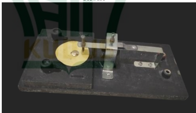
Gambar 4.12 Saklar Pada Ticker Timer Sebelum Revisi
