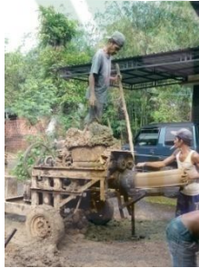
Penggilingan tanah liat menggunakan mollen
