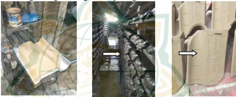
Genteng mentah setelah dicetak Diletakkan di rak-rak Di jemur disinar matahari
