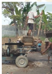
Pengolahan tanah liat dicetak dengan mesin
