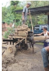
Pengolahan tanah liat dicetak dengan mesin
