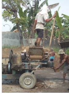
Penggilingan tanah liat menggunakan mollen
